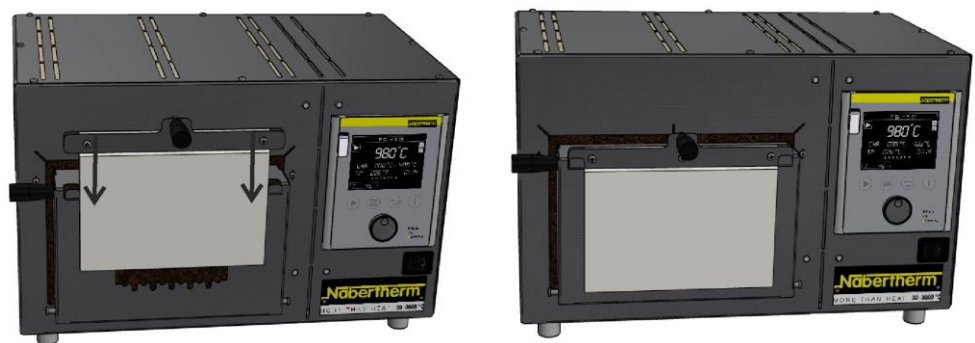
Abb. 25: Einhängen des Türvorhangs
