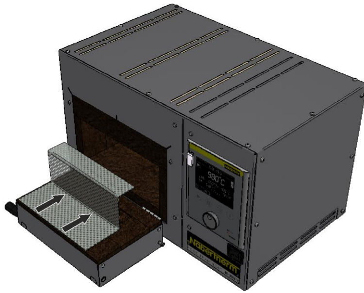
Abb. 13: Den mitgelieferte Lochblechwinkel, bündig zur Rückwand, in den Ofenraum stellen. (Abbildung ähnlich)
