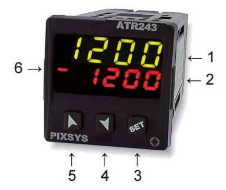
Mit dem Programmregler lässt sich eine langsame Aufheiz-Phase (Menü – GrAd -) bis zu einer frei wählbaren Trocknungstemperatur (Menü - Set 1 -) vorgeben. Nach Erreichen dieser Trocknungstemperatur fährt der Regler mit maximaler Aufheizgeschwindigkeit die Endtemperatur (Menü - Set 2 -) an. Die Brenntemperatur wird über die Brenndauer (Menü - A.t ı. -) gehalten. Danach schaltet der Regler auf - StoP - . Die Ist-Temperatur im Ofen wird weiter angezeigt.
